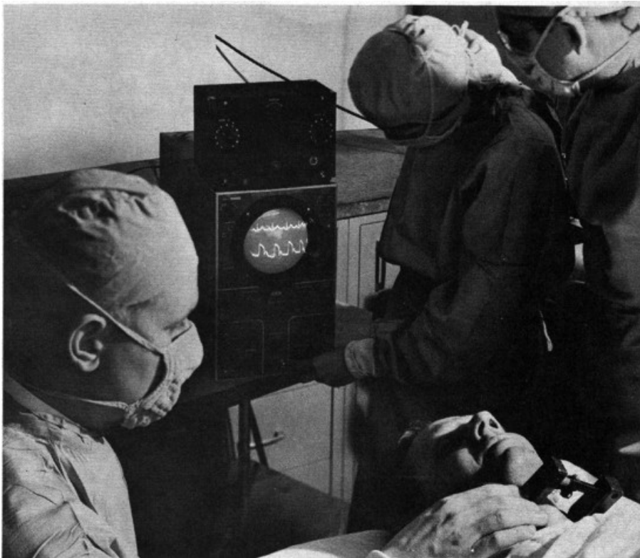
Osciloscopio electrónico de un solo haz que permite observar simultáneamente diversas funciones del organismo: la curva superior muestra el electrocardiograma y la inferior, el pulso arterial.
